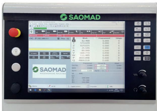
Interfaccia di collegamento con tutti i software di gestione europei. In grado di importare dati in formato BTL e BIM da tutti i programmi CAD/CAM del settore delle costruzioni in legno.
