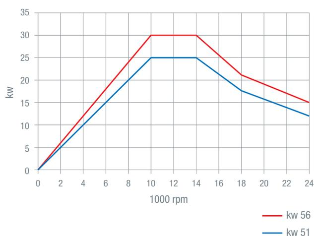
Il gruppo KAIROS a 5 assi con il suo cambio utensili può essere personalizzato a seconda della Vostre esigenze e darà valore aggiunto al Vostro acquisto. Se si desidera una potenza ancora maggiore è possibile equipaggiare la macchina con un elettromandrino da 25 kW in S1 e 30 kW in S6 ad alte prestazioni raffreddato. Non rinunciate mai alla massima redditività e realizzate grandi lavorazioni, con fresature o forature di qualità in tempi ridottissimi.
