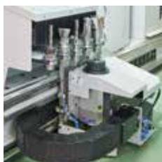
**ELETTROMANDRINO T2/H per lavorazioni sul lato inferiore completo di magazzino utensili supplementare.**
