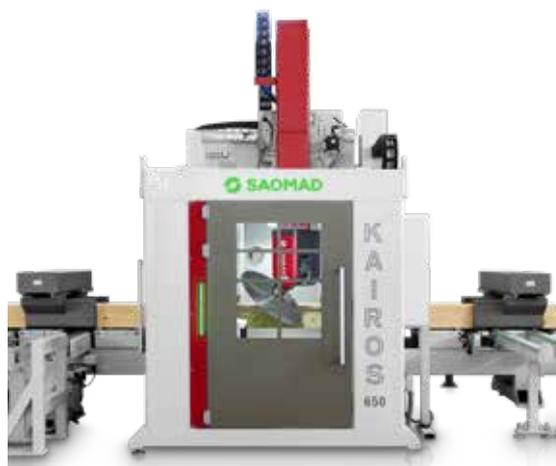
CABINA DOTATA DI CHIUSURA SUPERIORE E LATERALE per contenimento ed eliminazione delle polveri e dei rumori.
