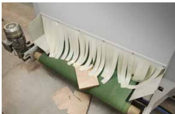
NASTRO TRASPORTATORE per smaltimento trucioli e scarti. Questi vengono eliminati tramite un ampio nastro trasportatore presente sotto la zona di lavoro.
